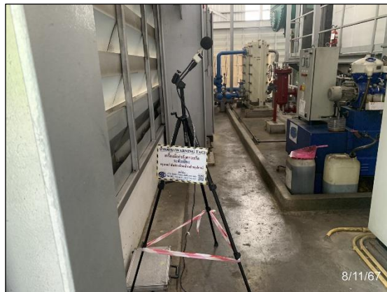
รูปที่ 3.15 การตรวจวัดระดับเสียงในสถานที่ทำงาน บริเวณ Steam Turbine No. 2
