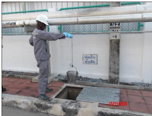
รูปที่ 3.9 การเก็บตัวอย่างน้ำ บริเวณจุดระบายน้ำทิ้งจุดที่ 2 จากโครงการเข้าสู่ระบบรวบรวมน้ำเสียของสวนอุตสาหกรรมเครือสหพัฒน์-ศรีราชา
