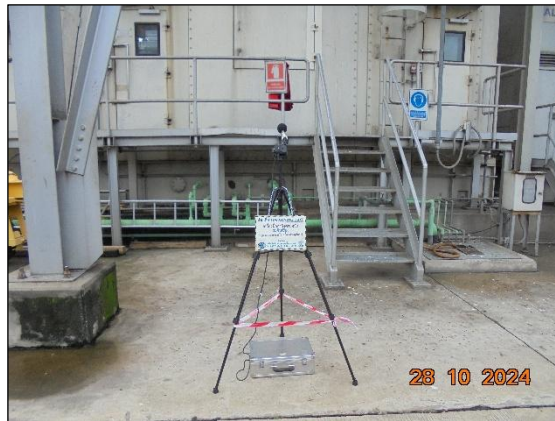
รูปที่ 3.17 การตรวจวัดระดับเสียงในสถานที่ทำงาน บริเวณ Gas Turbine No. 4
