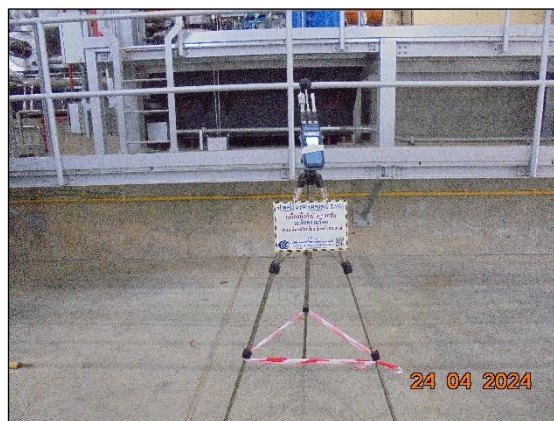
รูปที่ 3.24 การตรวจวัดระดับความร้อนในพื้นที่ทำงาน บริเวณ Steam Turbine 3
