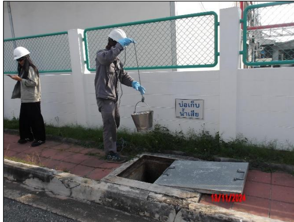
รูปที่ 3.8 การเก็บตัวอย่างน้ำ บริเวณจุดระบายน้ำทิ้งจุดที่ 1 จากโครงการเข้าสู่ระบบรวบรวมน้ำเสียของสวนอุตสาหกรรมเครือสหพัฒน์-ศรีราชา
