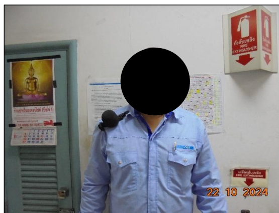
รูปที่ 3.20 การตรวจวัดระดับเสียงสะสมแบบติดที่ตัวบุคคล (Noise Dose)
