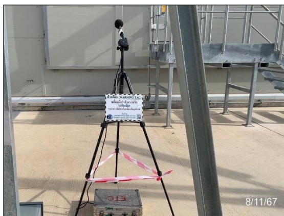
รูปที่ 3.19 การตรวจวัดระดับเสียงในสถานที่ทำงาน บริเวณ Gas Turbine No. 6
