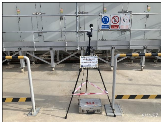
รูปที่ 3.18 การตรวจวัดระดับเสียงในสถานที่ทำงาน บริเวณ Gas Turbine No. 5
