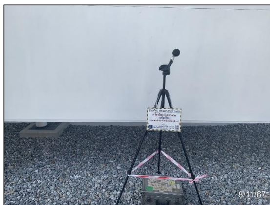
รูปที่ 3.16 การตรวจวัดระดับเสียงในสถานที่ทำงาน Steam Turbine No. 3
