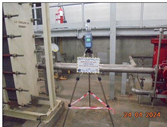
รูปที่ 3.23 การตรวจวัดระดับความร้อนในพื้นที่ทำงาน บริเวณ Steam Turbine 2
